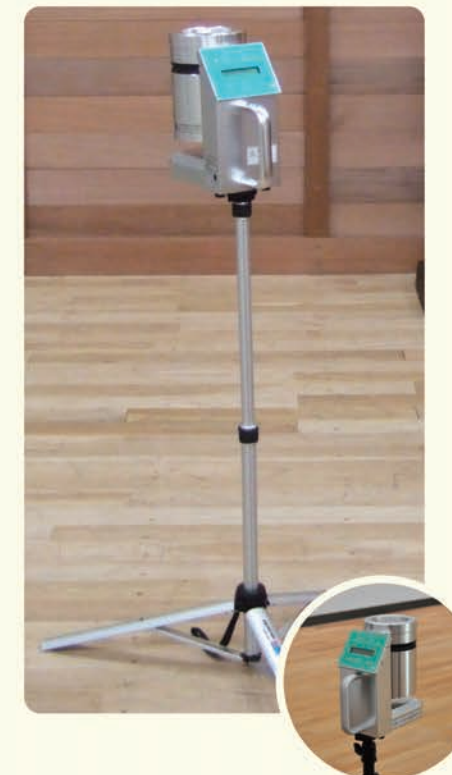
「エアースンプラー」による 浮遊菌検査
