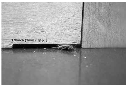
図1 チャバネゴキブリ3mm通過試験
