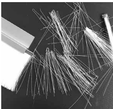
図3 切断によってメッキ鋼板タイプのブラシがバラバラになった例
