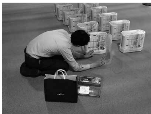
写真1 学芸員による温湿度計校正
