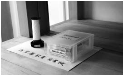
写真4 空気環境測定風景 左：トリエタノールアミン円筒ろ紙法 右：金属板腐食調査
