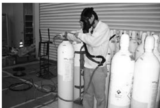
二酸化炭素、酸化エチレン対応の燻蒸装置
