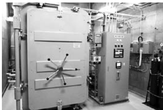
二酸化炭素、酸化エチレン対応の燻蒸装置
